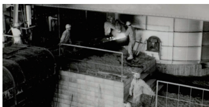
鉄回収工程の初出銑の様子
